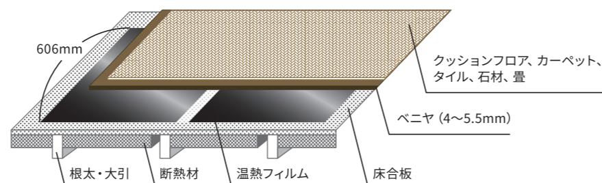
※仕上げ材は必ず床暖房対応の床材を使用してください。上記以外の床材の場合など、施工方法が不明の場合は担当者にお問い合わせください。
